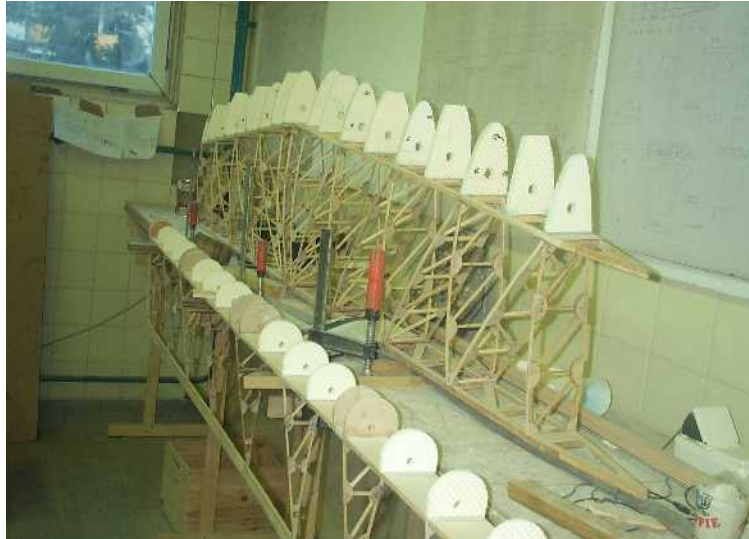
Höhenleitwerk im Rohbau
