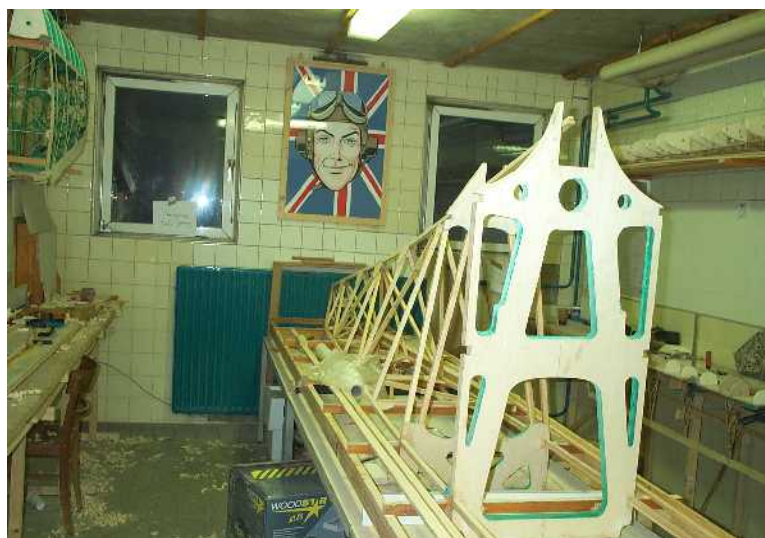
Der Bau des Rumpfwerks erfolgt auf einer Helling
