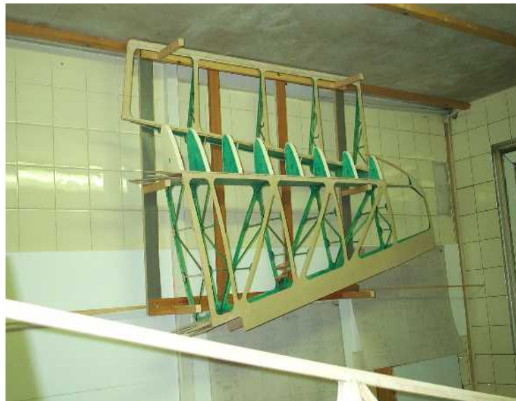
Seitenleitwerk fertig zur Abnahme durch den Bauprüfer
