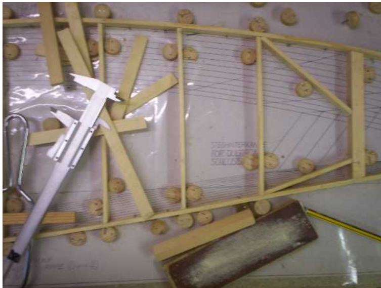
Bau von Flügelrippen in Schablonen
